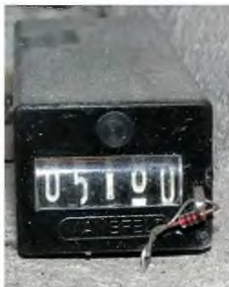
Рис.3.24. Электромеханический счетчик фирмы Mansfeld, рассчитанный на напряжение 10–15 В
