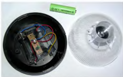
Рис. 3.52. Светильник PSL-80 с одним светодиодом лунного свечения и элементом солнечной батареи
