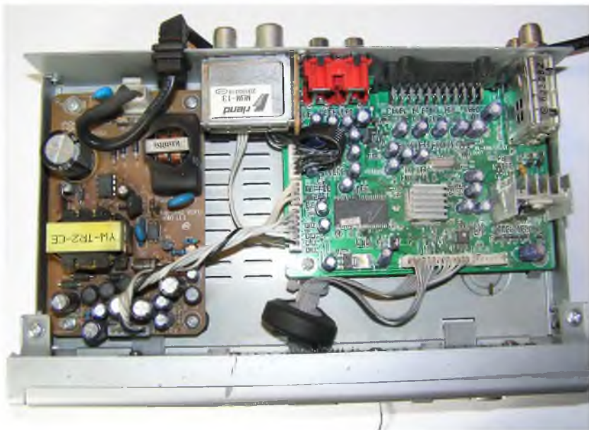
Рис. 3.19. Вид на печатные платы и элементы ресивера после снятия крышки корпуса
