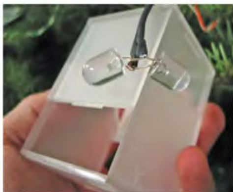
Рис. П. 17. Иллюстрация подключения двух светодиодов
