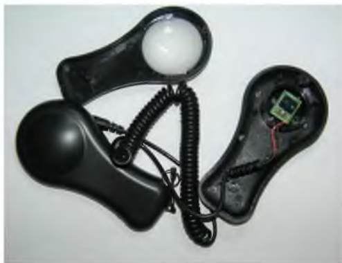
Рис. 3.15. Внешний вид выносного фотодатчика люксметра DVM401 с раскрытым корпусом
