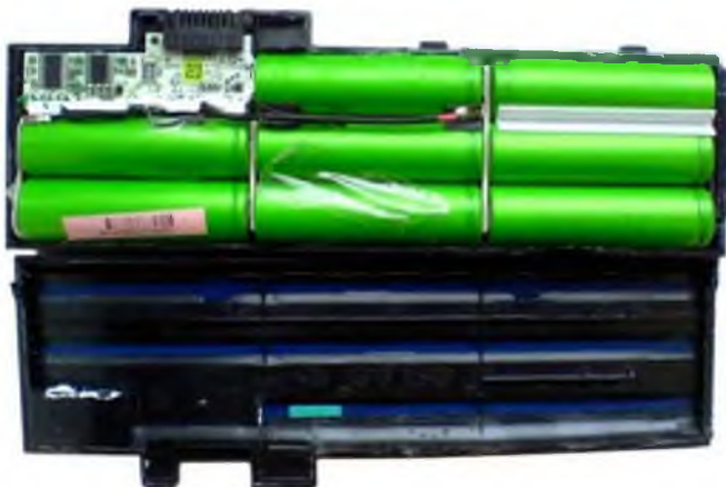
Рис. 2.8. Вид на снятую крышку корпуса АКБ ноутбука SQV-403
