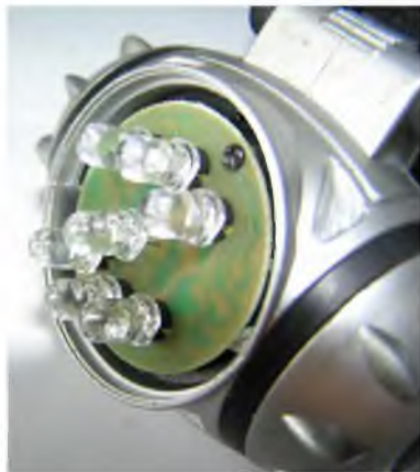
Рис. 1.24. Внешний вид (фото) коллиматора для семи светодиодов, выполняющих роль источника освещения в бытовом портативном электрическом фонаре
