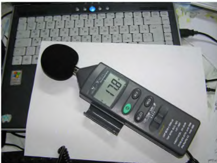
Рис. 3.6. Демонстрация показаний шумомера во время замера «фона» от ноутбука
