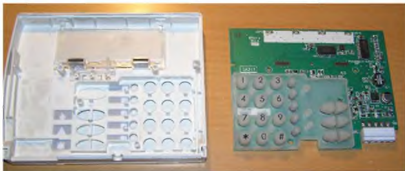
Рис. 3.21. Вид на разобранный (со снятой крышкой корпуса) блок «Сигнал-2М»
