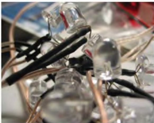
Рис. П.18. Иллюстрация подключения нескольких светодиодов параллельно
