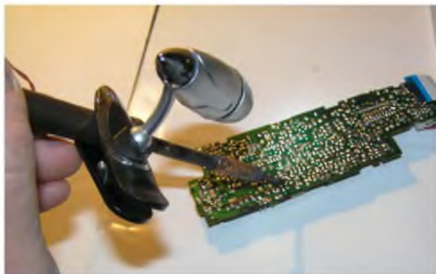
Рис. 1.26. Метод закрепления мини-светильника на ручке паяльника
