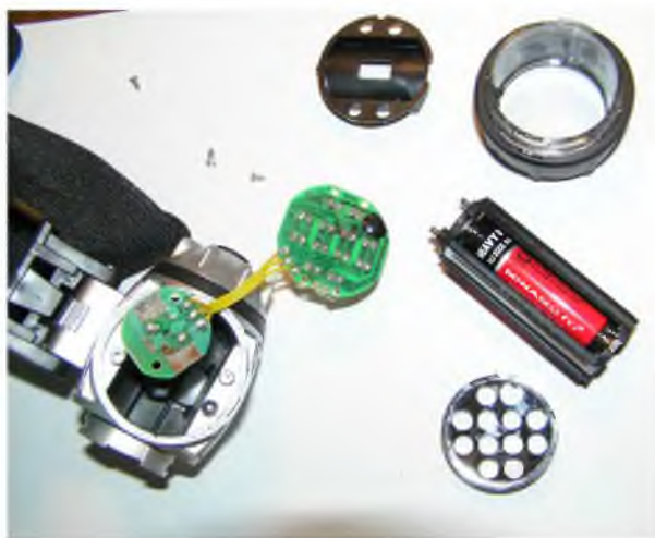
Рис. 3.42. Выемка двух печатных плат через стеклянную линзу
