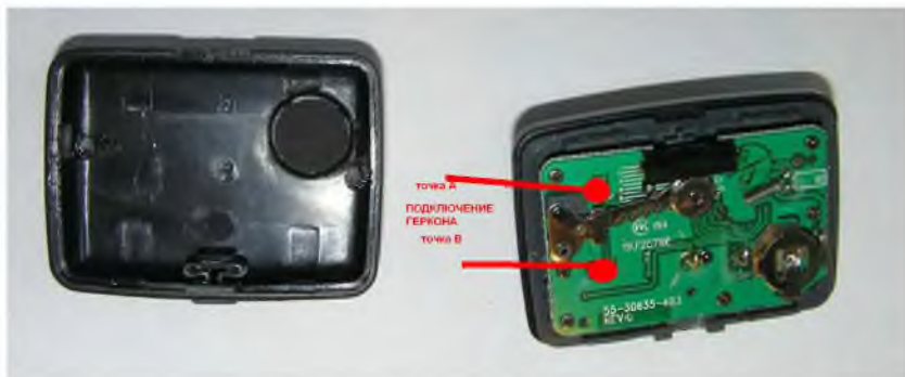
Рис. 3.28. Точки (А и В) подключения кнопки или геркона
