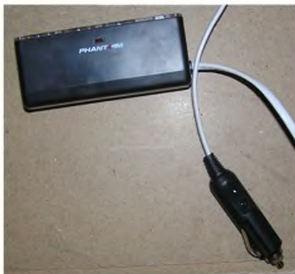
Рис. 3.59. Внешний вид устройства разветвителя, доработанного с помощью вышеприведенной рекомендации
