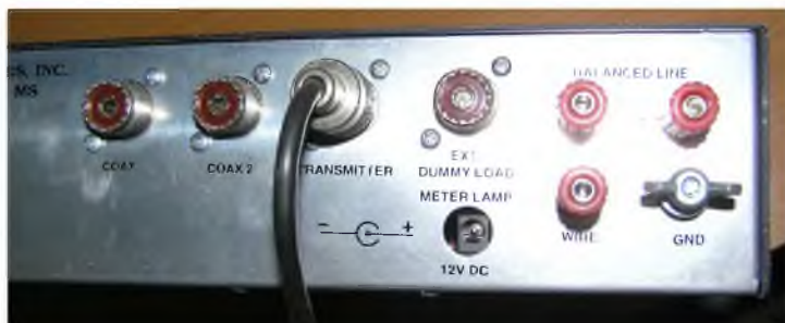
Рис. 3.51. Вид на заднюю стенку корпуса тюнера MFJ-941E с гнездом для подключения дополнительного источника питания
