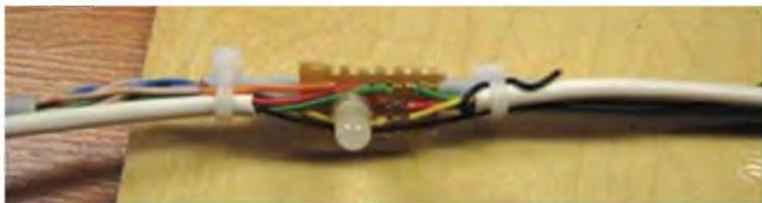
Рис. П.19. Метод надежного монтажа индикаторного светодиода на печатной площадке
