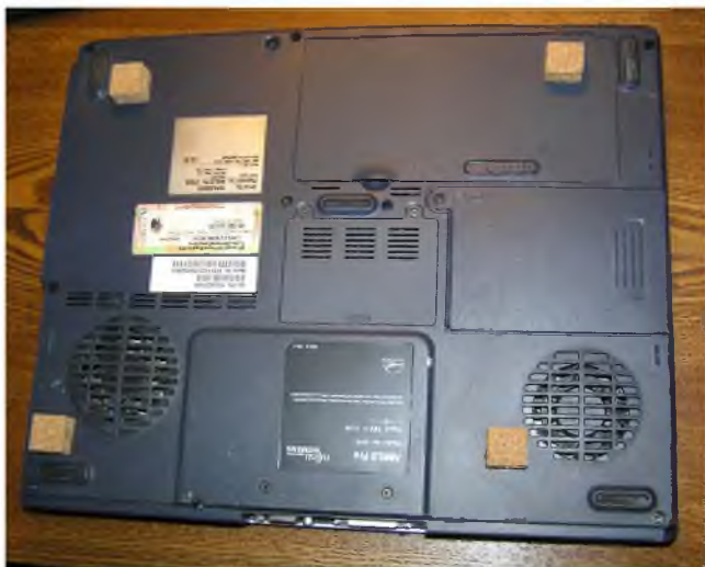
Рис. 2.3. Места установки «ножек» на корпусе ноутбука
