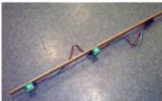
Рис. П.21. Монтаж светодиодов на рейках для организации разноцветной индикаторной панели
