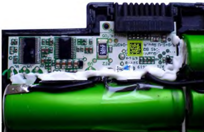
Рис. 2.9. Вид на плату контроллера заряда и состояния АКБ ноутбука
