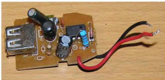
Рис. 3.57. Внешний вид печатной платы с установленными дискретными элементами и микросхемой
