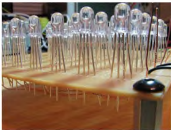
Рис. П.23. Монтаж большого количества светодиодов на печатной площадке
