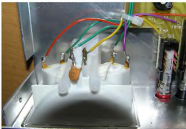
Рис. 3.54. Вид на вмонтированный в индикатор КСВ светодиод
