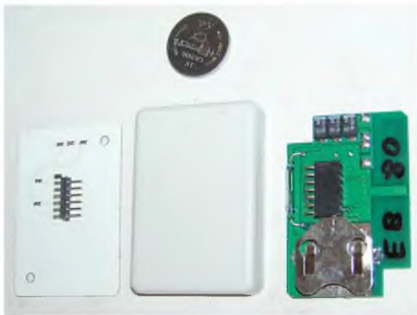
Рис. 3.40. Промышленный датчик влажности в разобранном состоянии
